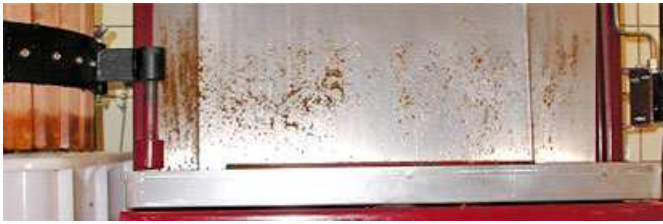
Foto 21 zeigt eindrucksvoll die Saftspritzer mit Trubstoffen am hinteren Spritzschutzblech bei ausgeschwenktem Presskorb.
