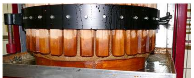
Foto 13: Angehobener Presskorb mit durchgerutschtem Pressbeutel und eingelegtem Boden aus Fichte-Leimholz.
