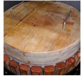
Foto 15: Pressdeckel aus Fichtenleimholz mit unterer Sägezahnplatte.
