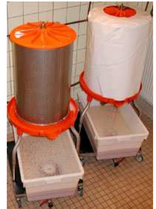
Foto 19 : 90-Liter-Hydropressen im Einsatz. Links ohne und rechts mit Spritzschutzhaube.
