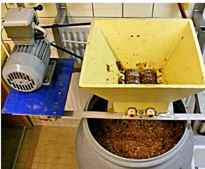
Foto 31: Variante 2, Trestermühle mit untergestelltem Fass 220 Liter. Das Fass nimmt den Trester aus 500 Kg Obst auf.
