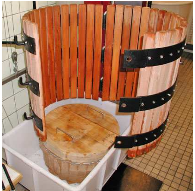
Foto 28: Für den Fall, dass der Trester bei überreifer Maische fest an die Korbwand gepresst, oder der Pressdeckel verklemt ist und sich nicht aus dem Korb heben lässt, kann der Presskorb seitlich geöffnet werden.
