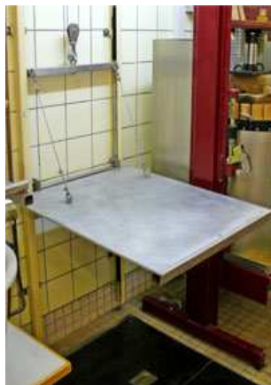
Foto 27: Die Konstruktion des Hebetisches, auf Arbeitsebene positioniert.
