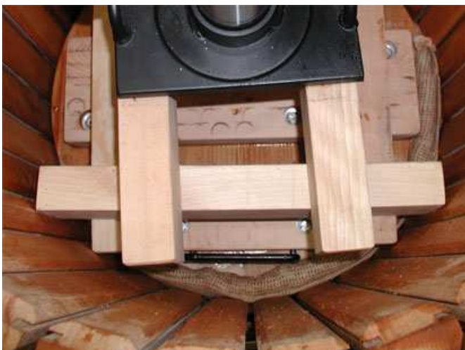
Foto 14: Ansicht von oben in den Presskorb. Am Originalpressdeckel wird der Pressbeutel auf halben Korbumfang durchgedrückt.
