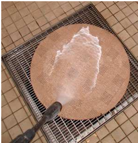
Foto 8: Im Wasserbad aufgeweichte Imprägnierung wird mit dem Hochdruckreiniger ausgetrieben.
