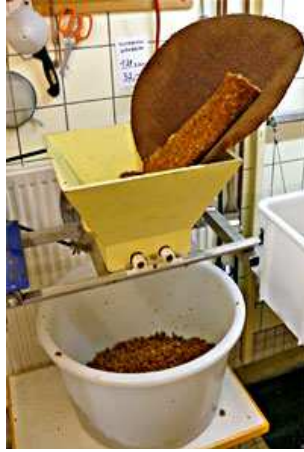
Foto 30: Variante 1, Trestermühle mit untergestellter Bütt.
