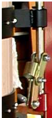
Foto 17 , Original Scherengelenk bei Anlieferung.
