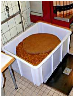
Foto 26: Auf den Boden abgesenkter Hebetisch, gefüllt mit den Tresterscheiben und Einlagen einer Presse.
