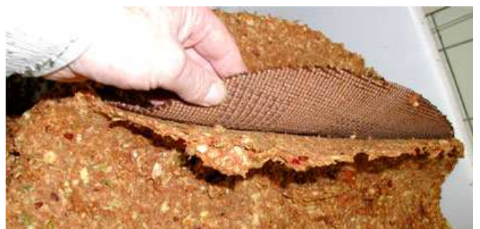
Foto 29: Die dünnen, festen und zähen Tresterscheiben lösen sich leicht von den Einlagen.
