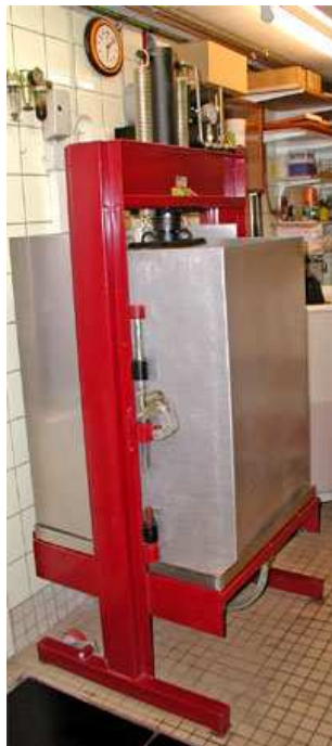
Foto 22: Einhausung des Presskorbes mit Spritzschutzblechen für die Endreinigung.
