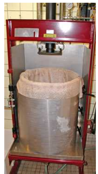
Foto 20 : Einsatz von zwei sich seitlich überlappenden Spritzschutzblechen für den Füllvorgang.
