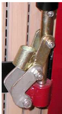
Foto 18 , Unterteil des Scherengelenkes gegen V2A Winkelbleche getauscht.
