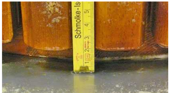
Foto 12: Hochgedrückter Presskorb, im Hintergrund der Einlegeboden aus Fichte-Leimholz.
